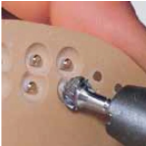
Speciální tvrdokovová fréza na obnažení čepů
